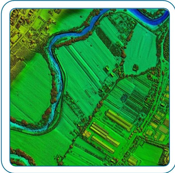
Il Modello Digitale delle Superfici First pulse (DSM\_First) con effetto shading
